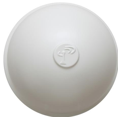
Plastový kryt z kvalitního UV-stabilního ABS plastu pro paraboly MaxLink 22dBi 5GHz 30cm. Kryt slouží jako ochrana před nežádoucími vlivy (námraza, sníh, listí, atd.). Kryt je vhodné použít na nepřístupná místa a v horských oblastech. Kryt lze jednoduše namontovat na parabolu pomocí 6 samořezných šroubů do předvrtaných otvorů v parabole. Šrouby jsou součástí balení.
