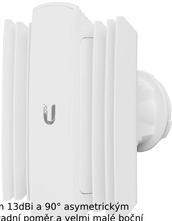
PrismAP-5-60 je 5GHz sektorová anténa se ziskem 13dBi a 90° asymetrickým vyzařovacím úhlem. Anténa nabízí skvělý předo-zadní poměr a velmi malé boční laloky. Asymetrické sektorové antény jsou ideální pro instalaci více jednotek na jeden vysílací bod pro připojení více klientských stanic.
